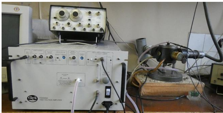
Електричен и оптичен модули на апаратурата за получаване, модифициране и характеризиране на микрочастици чрез електрооптични методи
