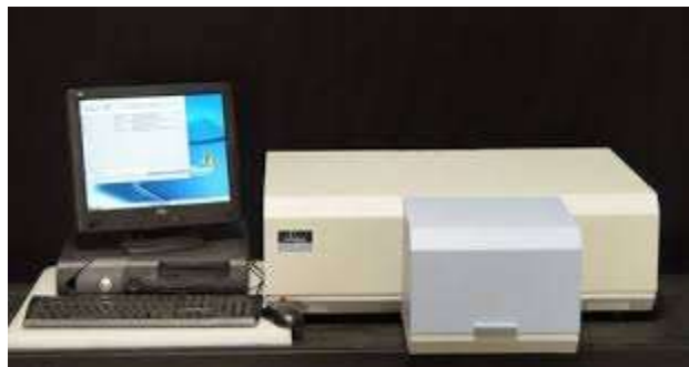
Луминесцентен спектрофотометър (квантов добив на твърди проби)
