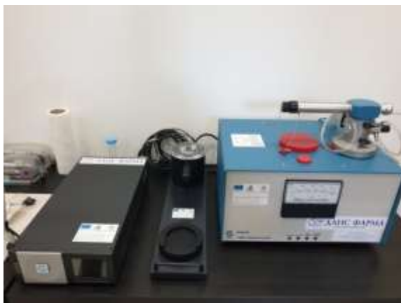
Апаратура за подготовка на нано-обекти (предварително замразени) за наблюдение с ТЕМ
